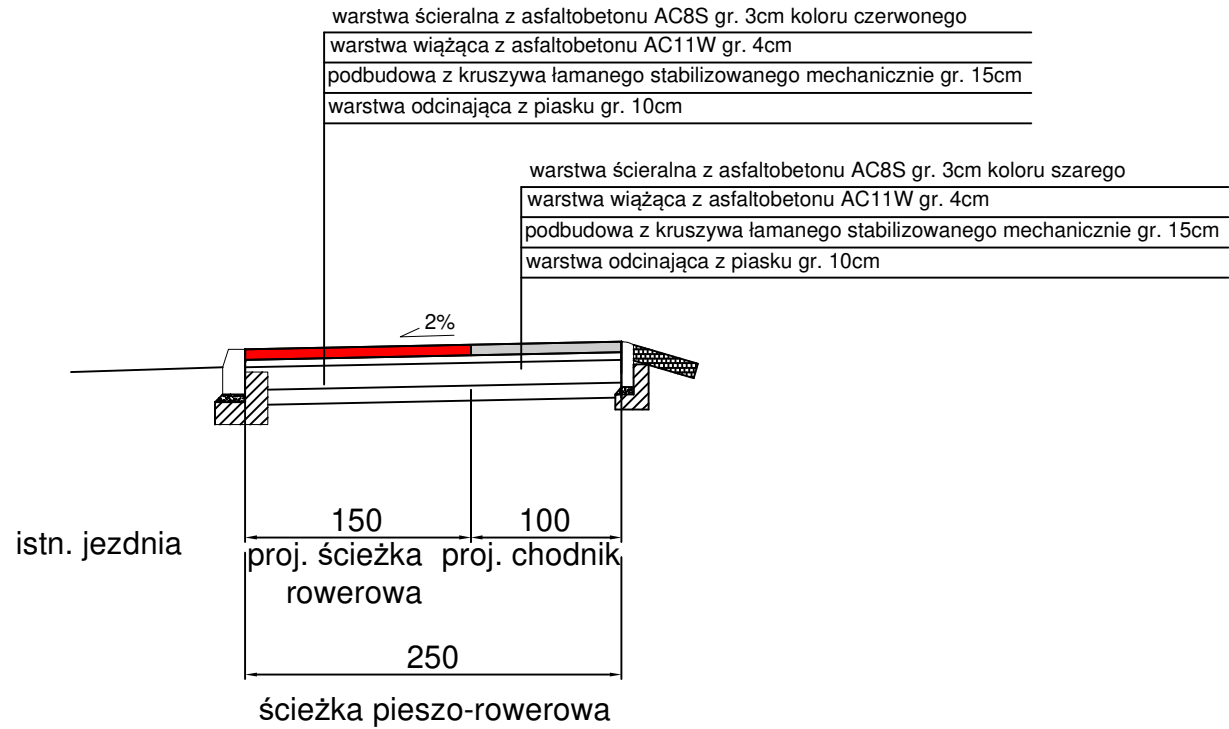
PRZĘKRÓJ NORMALNY ŚCIEŻKI PIESZO-ROWEROWEJ SZEROKOŚCI 2,5m
